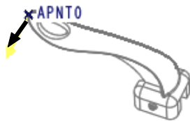
图 6.9 定义修剪方向
