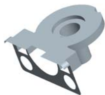
图 14.20 创建主分型曲面
