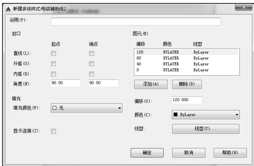
图 2-64 电话辅助线 2 的多线样式设定
