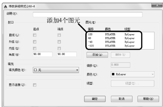
图 7-50 设置完毕的【修改多线样式: 240-4】对话框
