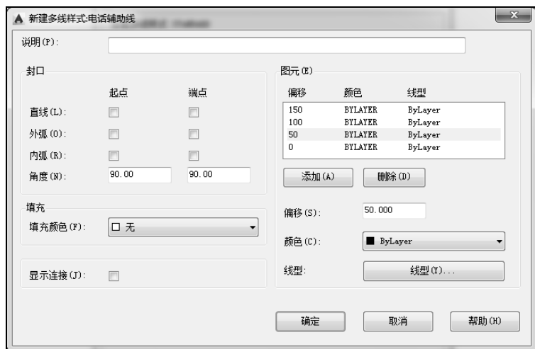
图 2-63 电话辅助线的多线样式设定
