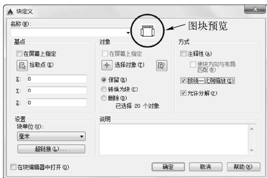
图 4-4 设置完毕后的【块定义】对话框
