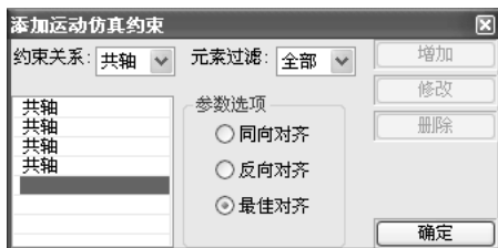
图 5-133 定义了 4 个共轴的约束关系
