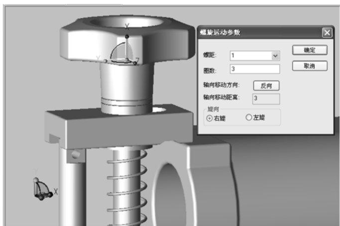
图 5-101 定义把手的螺旋运动
