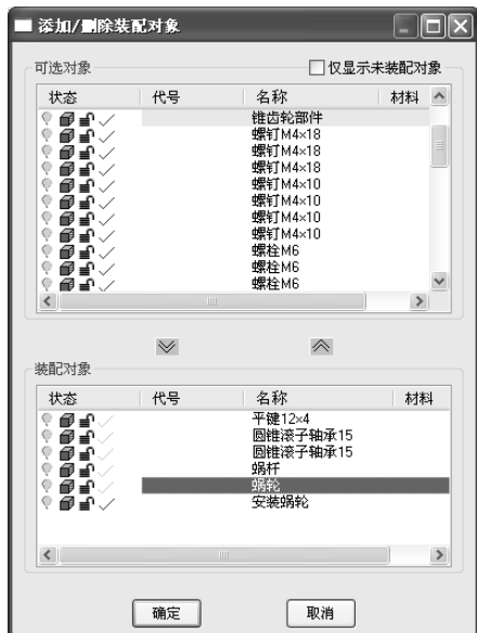
图 3-49 添加“蜗轮”到工序“安装蜗杆”中
