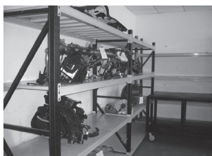
图 3-28 拆件悬挂标识分类上架
