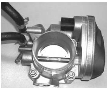
图 3-38 电子节气门系统
