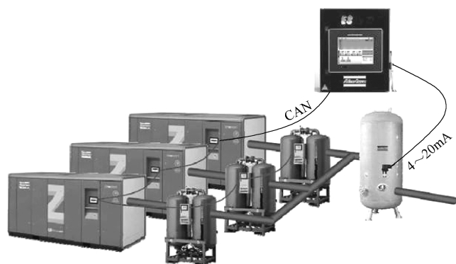
图 3-15 ES+联控系统示意图
