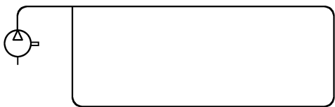
图 10-8 环形管网结构
