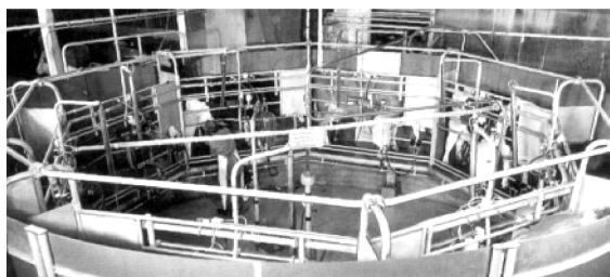
图 12-28 采用热浸镀锌处理的挤奶用旋转装置，可提高奶牛的挤奶效率
