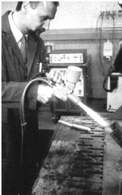
图 7-26 采用热喷涂修复镀锌层缺陷
