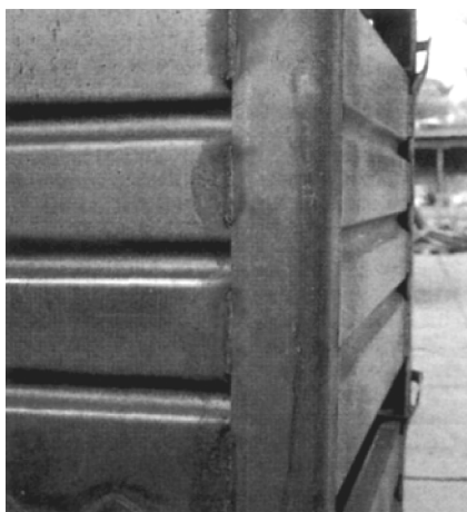
图 7-33 焊接时因热冲击使油和脂燃烧造成的热浸镀锌缺陷
