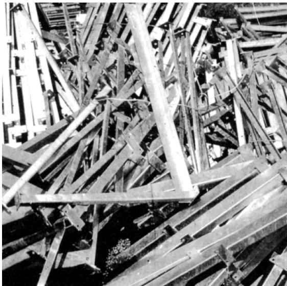
图 9-13 热浸镀锌角钢结构件储存不当，不利于水排出，易产生白锈 (杜塞尔多夫, 德国镀锌协会 [2] )
