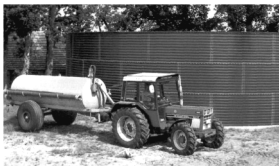
图 12-29 用于运输液体废料的罐车，液罐采用热浸镀锌 + 涂装防腐处理
