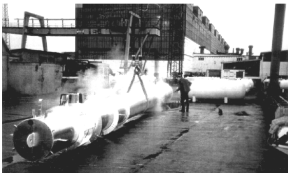
图 10-7 镀锌层表面高压水喷射清洗（施耐德）
