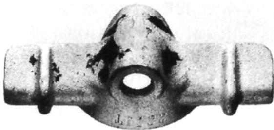
图 7-27 因铸件粘砂而造成的镀锌层缺陷
