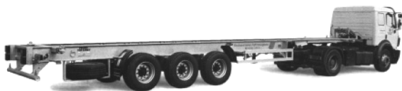
图 12-15 针对客户的要求，热浸镀锌技术成功应用于汽车领域，特别是应用于货车的制造过程（如德国 schmitz 公司的 CargoBull 运输车），当然也用在宝马 Z3 车的横梁上（图中为货车的热浸镀锌底盘框架，照片来源于 Rietbergwerke GmbH & Co KG 公司）
