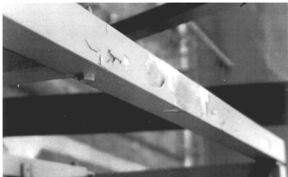
图 10-3 预处理不到位或涂层材料选择不当造成的涂层剥离（施耐德）
