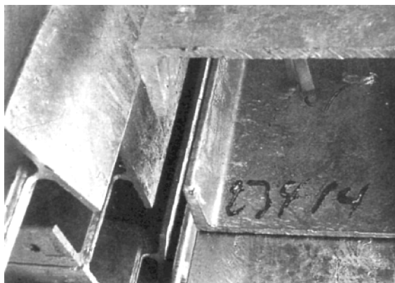
图 7-2 残留标记所造成的镀锌层缺陷
