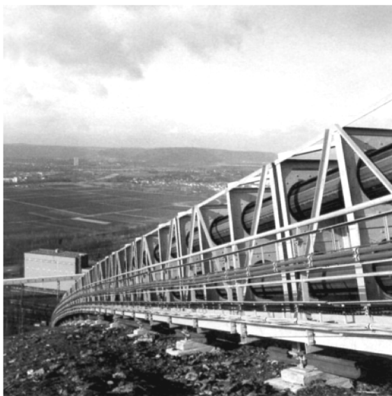
图 12-22 建于 Ens Dorf/Saar 的管道输送系统，可实现传输距离为 350m、高度差为 130m 的煤或矿石的低排放环境友好型输送
