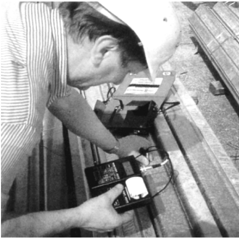
图 8-3 热浸镀锌产品的终检（测量镀锌层厚度）
