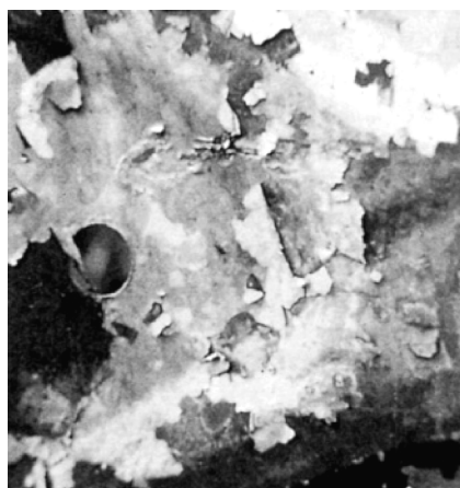
图 7-34 镀件暴露于高温环境中时发生的纯锌层脱皮（Kirkendall 效应）
