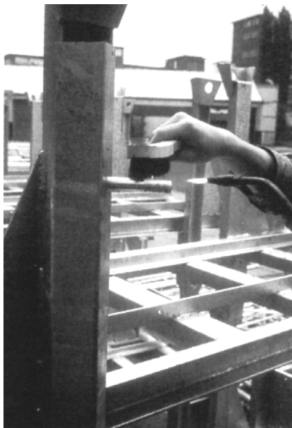
图 7-24 采用焊接火焰和钢丝刷将锌瘤去除
