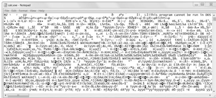
图 8-5 在 Notepad 中打开 Windows 的 calc.exe 程序
