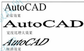
图 7.5 AutoCAD 字体宽度比变化和倾斜效果
