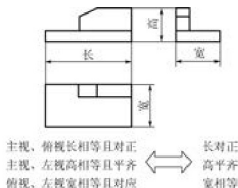
图 4.4 三视图之间度量的对应关系
