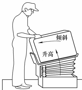
b) 采用可倾斜和升降的工作台可避免弯腰取物
