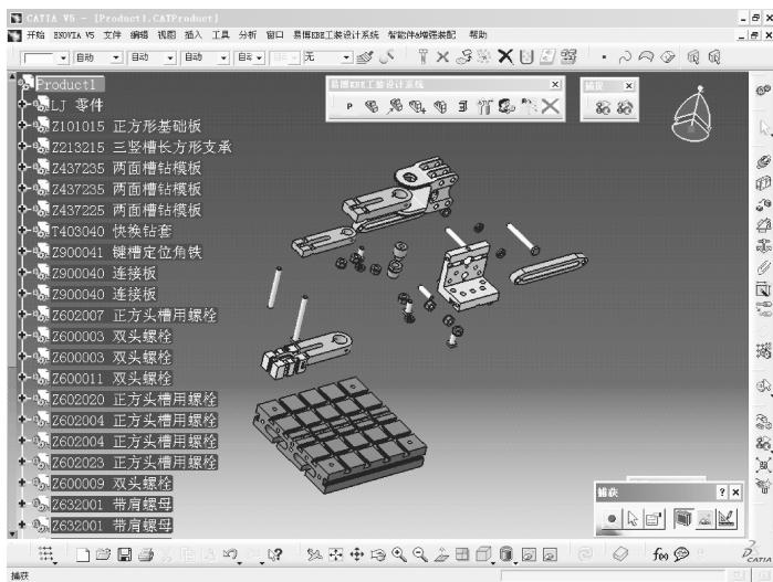
图 6-29 匹配底层基础板
