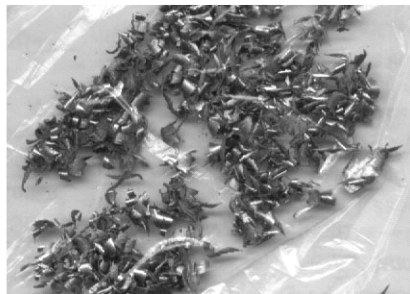
图 4-61 无任何冷却介质 切削时的切屑形态
