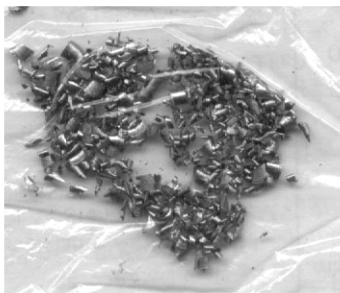
图 4-60 传统油冷却 切削时的切屑形态
