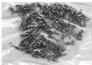
图 4-58 低温气体射流冷却切削时的切屑形态
