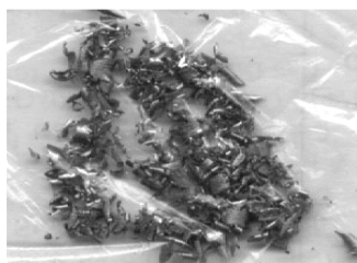
图 4-59 冷风射流冷却切削时的切屑形态
