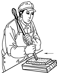
图 6-11 靠肩法精磨刮刀端面
