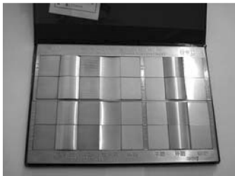
图 1-17 表面粗糙度比较样块
