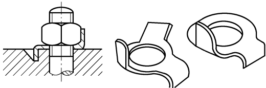
图 11-32 止动垫圈防松装置
