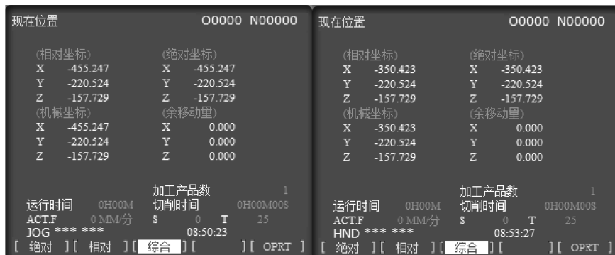
图 3-29 对刀操作时的位置界面
