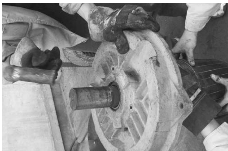
图 2-14 将后端盖安装到转子上
