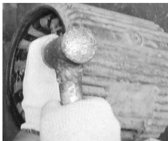
图 2-48 冷拆法拆除绕组
