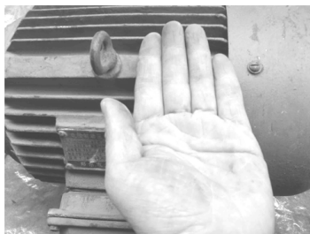
图 2-29 用手背检查电动机外壳是否过热
