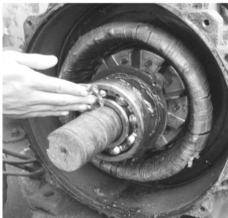
图 2-16 向另一侧轴承及轴承盖上加油
