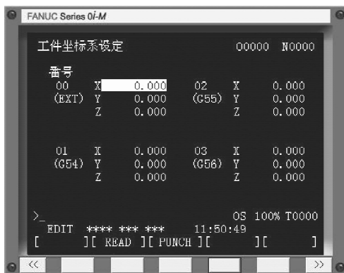
图4-26 工件坐标系设定界面
