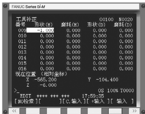
图 4-25 设定刀具补偿示例
