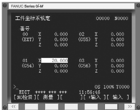
图4-27 设定X向工件原点偏移值
