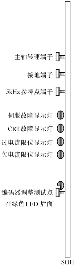
图 3-54 SOH 板上编码器电源检测点示意图
