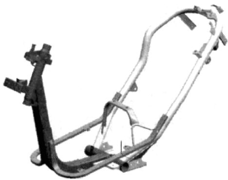
图 10-3 摩托车车架典型结构
