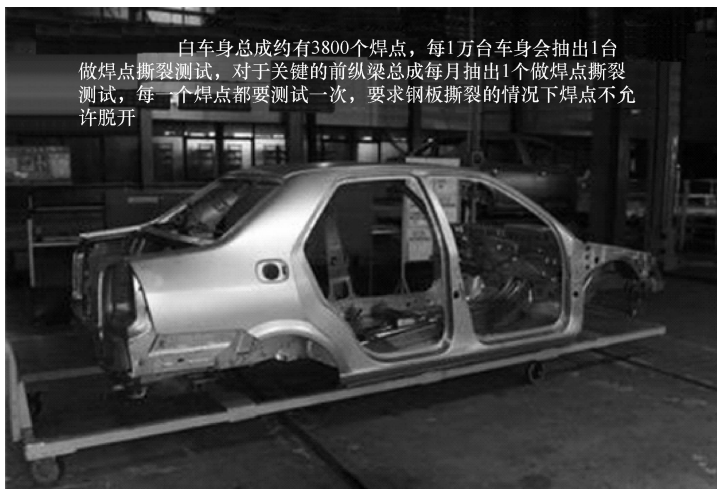
图 1-39 车身焊点的检测要求
