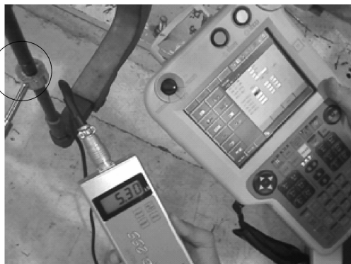
图 5-49 用加压计测量焊钳的压力
