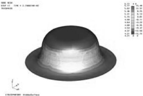
图 4-4 端盖第一次拉伸厚度分布图
