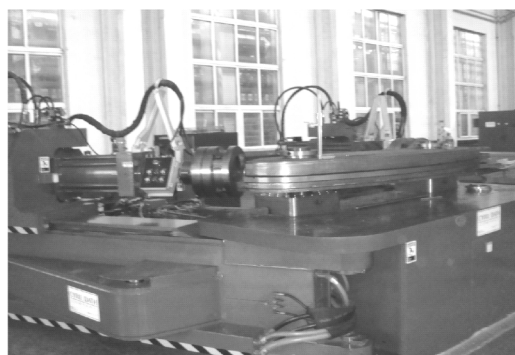
图 3-19 V75 型数控拉弯机
