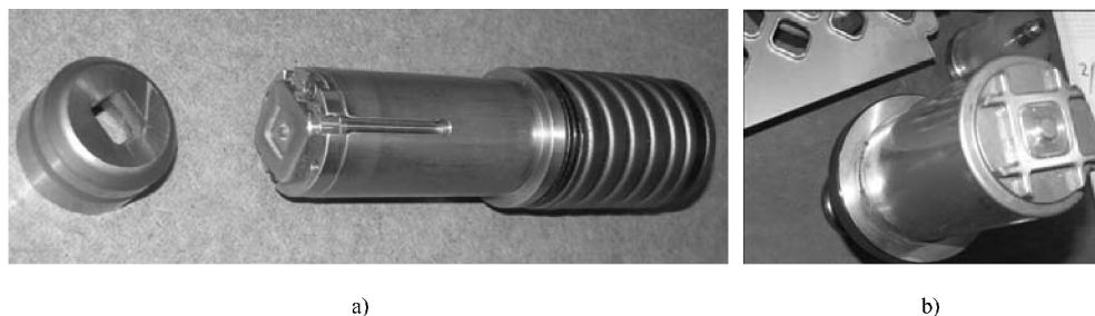
图 3-87 转塔冲床冲孔、翻边模具
