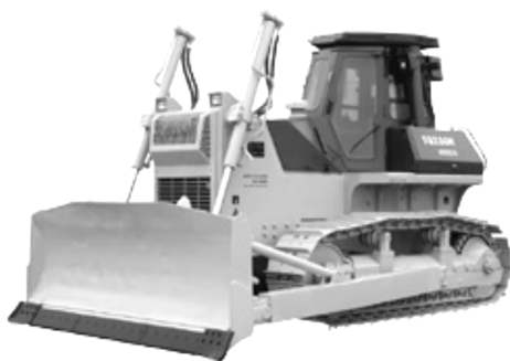
图 1-5 三一重工的 TQ230H 型 静液压驱动履带式推土机
