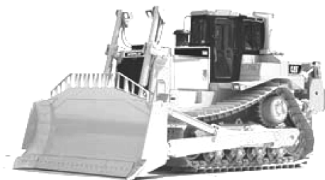
图 1-1 卡特彼勒公司的最大推土机 D11R CD 型
