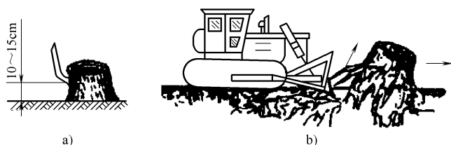
图 3-46 铲除直径 20cm 以下的树根
