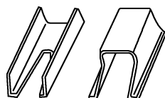
图 1-19 削弱帽形件末端以增加接头柔性
