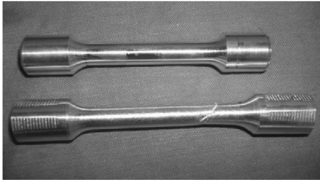
图 5.15 ECAP 变形 4 道次 1.0wt% MWCNTs 复合材料后室温拉伸前后的宏观形貌对比
