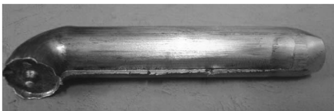
图 2.10 ECAP 变形 1 道次后的 MWCNTs 增强镁基复合材料试样
