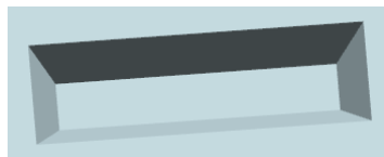
图 6.1.10 凹坑边不使用圆角过渡
