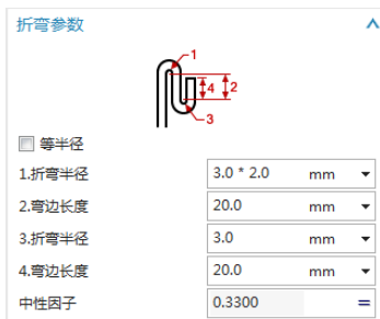
图 3-82 “S 型”折弯参数
