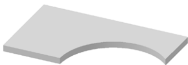
图 8.1.5 创建基础突出块钣金壁
