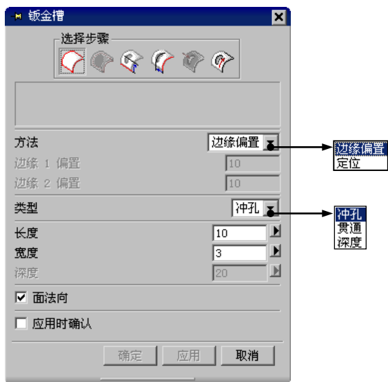
图 5.3.4 “钣金槽”对话框
