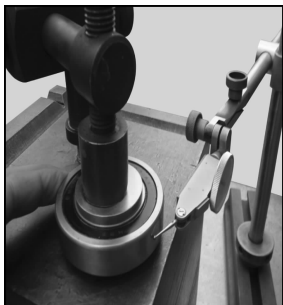
图 10-7 检查轴承的 径向间隙
