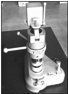
图 10-1 轴承简易检查仪
