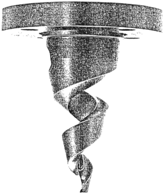
图 9-11 法兰连接的实心螺旋喷嘴
