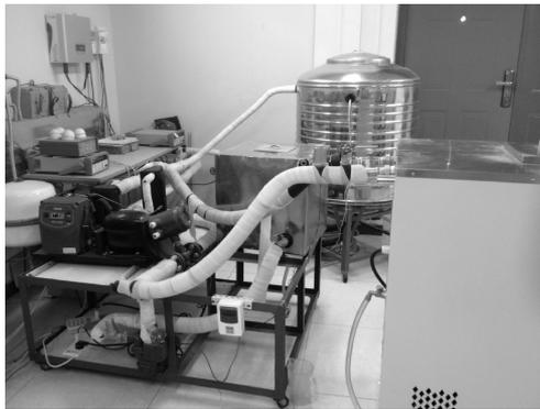
图 3-2 热管式太阳能 PV/T 热泵系统实验台室内部分
