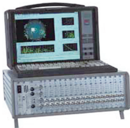
图 1-6 德国 Vallen 公司 AMSY-5 声发射检测系统
