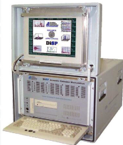
图 1-3 DISP 声发射检测系统
