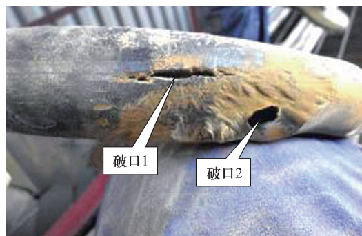
图 3-1 长期过热爆管的破口实物
