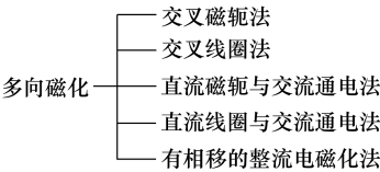
图 5-5-3 多向磁化法分类
