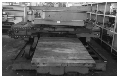
图 3-2 再制造前的机床导轨
