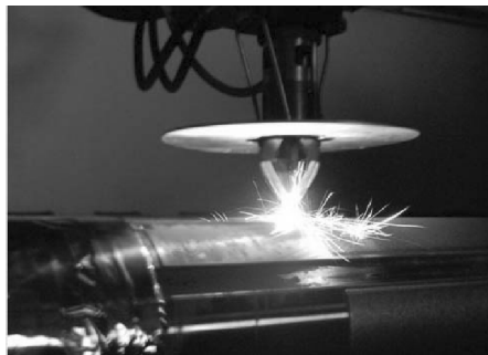
图 5-8 废旧机床导轨激光熔覆过程
