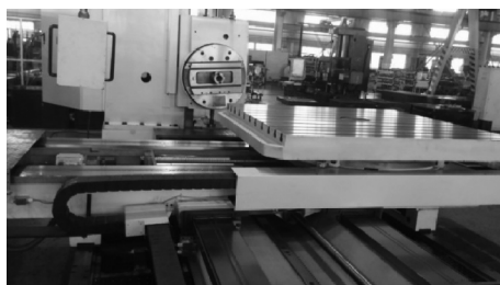
图 3-3 再制造后的机床导轨
