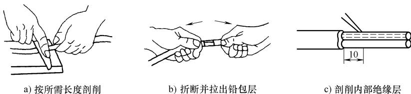
图 3-30 铅包线绝缘层的剖削
