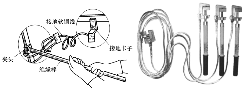
图 3-17 携带型接地线
