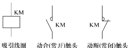
图 3-12 接触器的图形符号与文字符号
