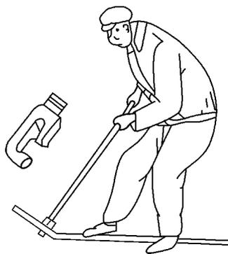
图 9-14 管柄弯管器的结构
