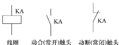
图 3-15 中间继电器、电磁式电压继电器及电磁式电流继电器的图形符号与文字符号
