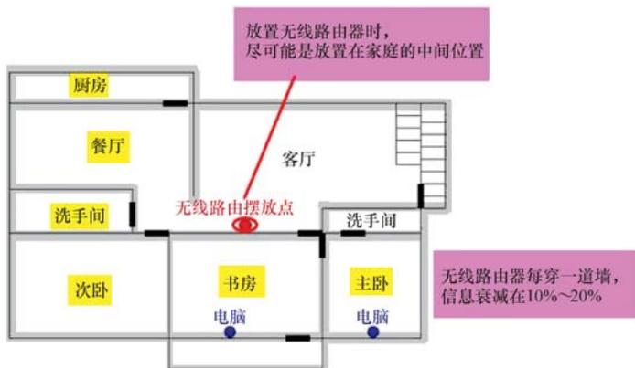
图 2-13 路由器放置的最佳方位图例
