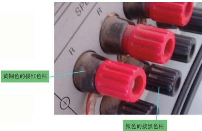
图 5-30 音频线的连接
