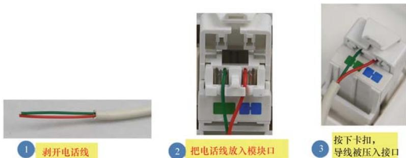
图 4-38 电话插座面板的连接
