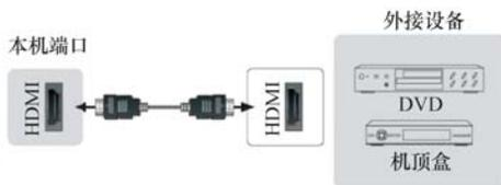
图 4-20 电视机以 HDMI 线连接的图例
