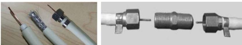
图 4-3 电视机同轴电缆与其连接
