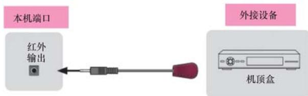
图 4-27 电视机连接红外设备的图例
