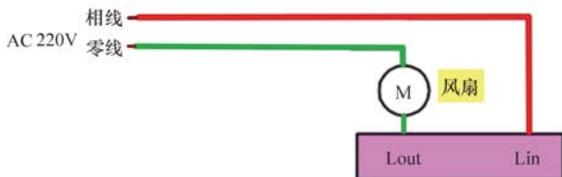
图 6-14 遥控带灯风扇智能开关常见的接线方法
