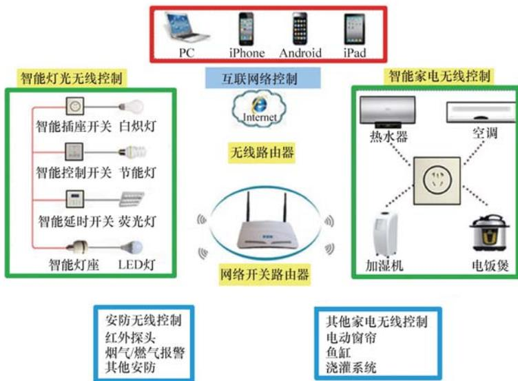
图 6-1 互联网络控制系统图例
