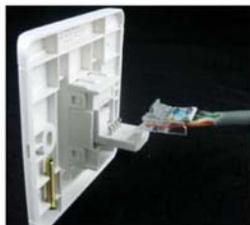
对应每个线和槽，用打线钳将网线用力压入槽内。道口向外，以切断网线与槽壁相齐
