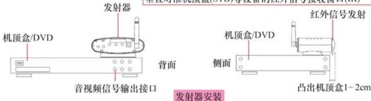
图 4-32 数字机顶盒无线共享器的安装与连接(续)
