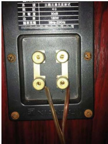
图 5-1 音箱接线柱
