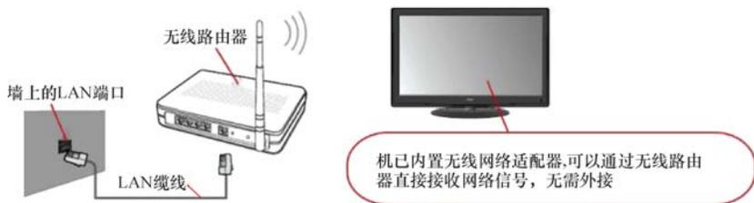
图 4-23 电视机连接无线网络的图例
