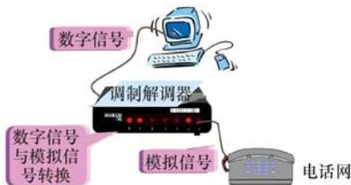
图 2-4 网络硬件连接图例
