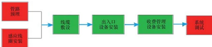
图 8-15 停车、车库管理系统施工工艺流程
