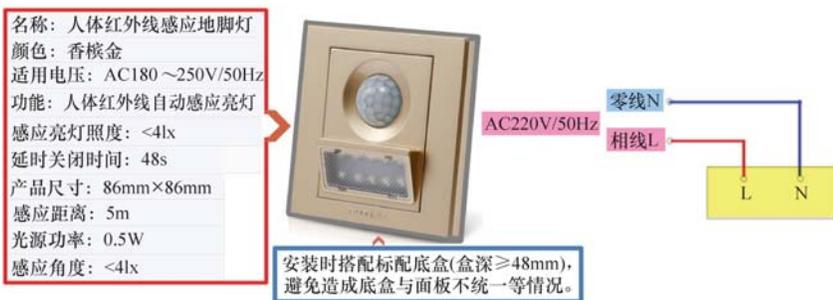
图 1-27 人体红外线自动感应地脚灯的安装
