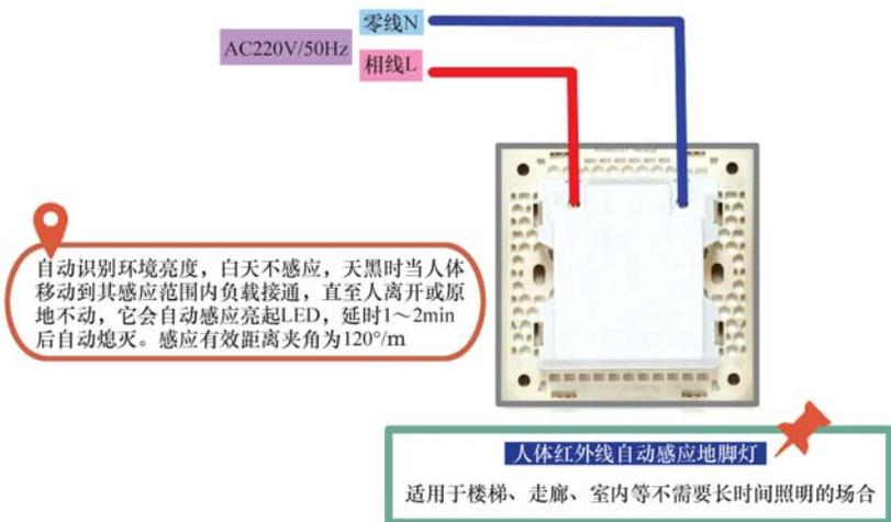
图 1-27 人体红外线自动感应地脚灯的安装 (续)
