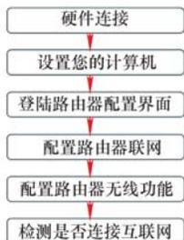
图 2-22 无线宽带路由器安装流程
