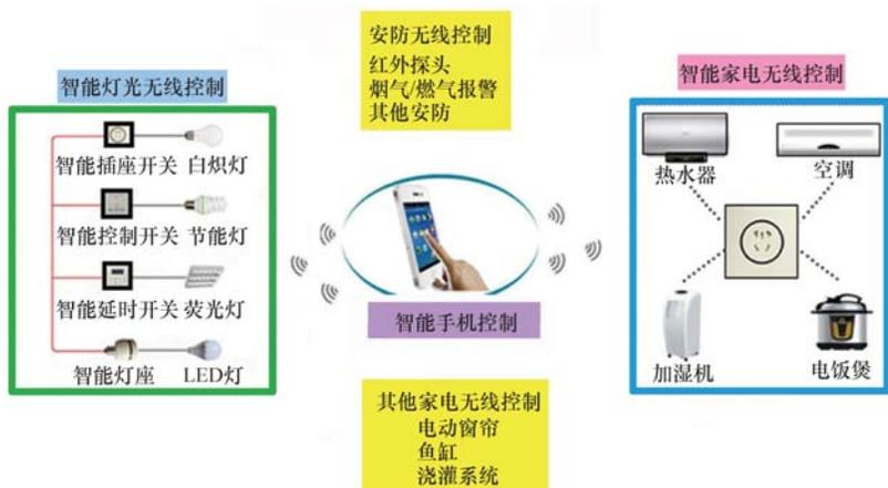
图 6-2 智能手机直接控制系统图例
