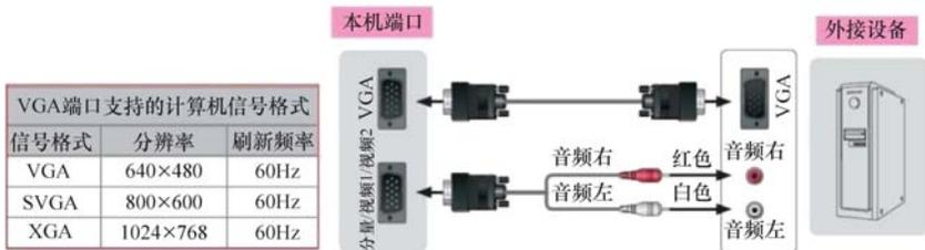
图 4-21 电视机连接电脑的图例
