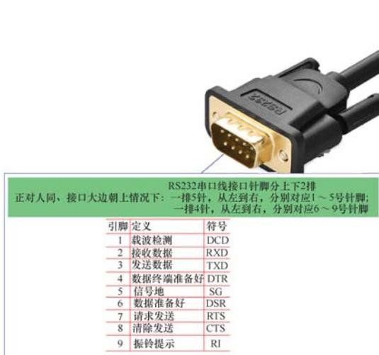
图 2-26 RS232 串口线接法与线芯引脚定义
