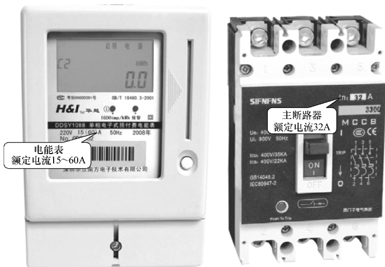
图 3-6 电能表和主断路器的额定电流
