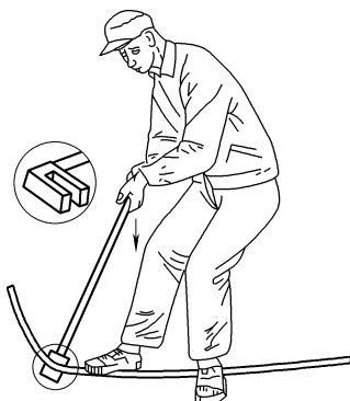
图 4-5 中小型电线管的弯曲方法
