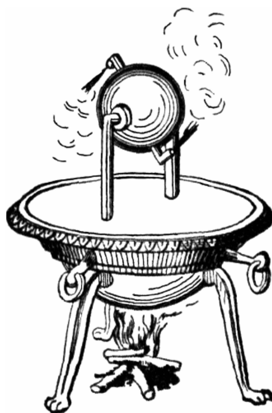
图6-1 汽转球是已知最早以蒸汽发动的机器，由亚历山大港的希罗首先提出（来源：Knight's American Mechanical Dictionary, p.17, 1876）
