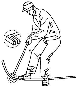
图 1-83 中小型电线管的弯曲方法示意图
