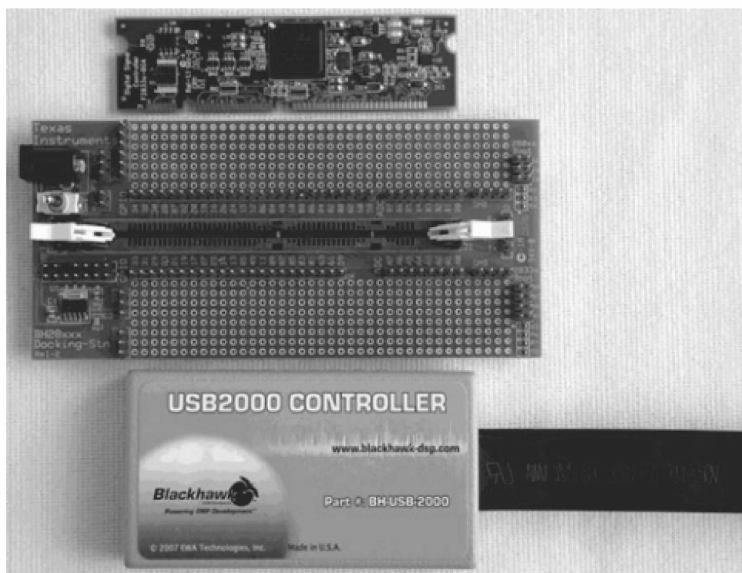
图 4-18 软硬件开发系统：F28335 控制卡、CC28xxx 对接板和 USB2000 控制器
