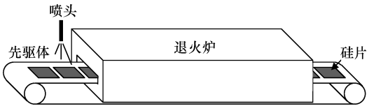
图 4.5 传送带式退火炉示意图。硅片通过机械手装载及卸载到传送带上。在硅片进入到退火炉前，将液态磷源喷涂到硅片上。退火炉温度设置为约 900℃，硅片在退火炉中传送过程约为 20min
