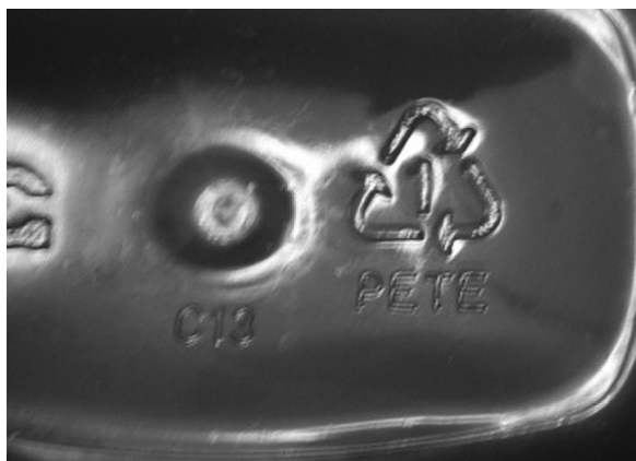
图 5.6 回收过程中使用的 SPI 树脂辨认标志
