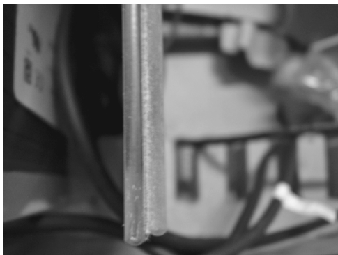
图4.7 薄膜组件的边缘，背景为纸板间隔物。这些组件用纸板包装运送，并在间隔物之间垂直排列
