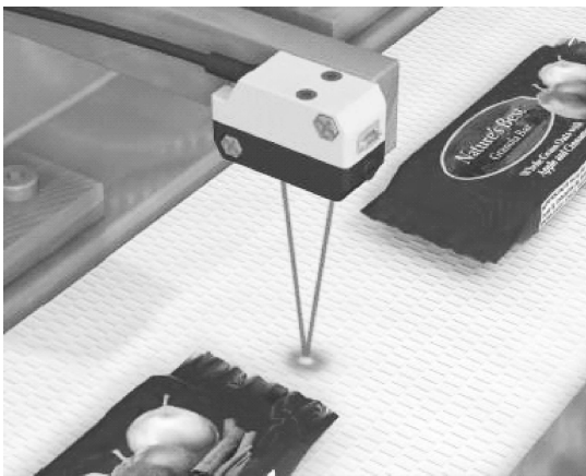
图 1-4 食品包装传输线上的食品到位检测用光电传感器
