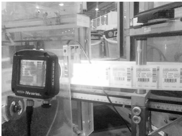
图 5-76 视觉传感器安装于设备上对标签进行检测
