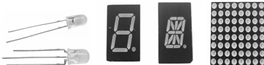
图 2-25 发光二极管常用器件实物外形
