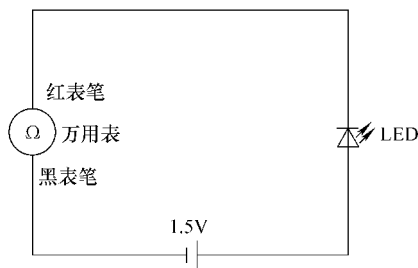
图 2-28 发光二极管的极性检测
