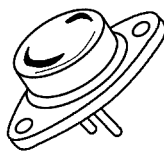
图 2-56 功率开关晶体管
