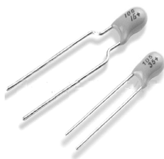
图 1-60 钽电解电容器 (CA) 和铌电解电容器 (CN)
