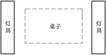
图 6.4 不产生光幕反射的布灯方案
