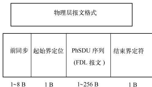
图 5-17 总线上的 Profibus-PA 数据传输
