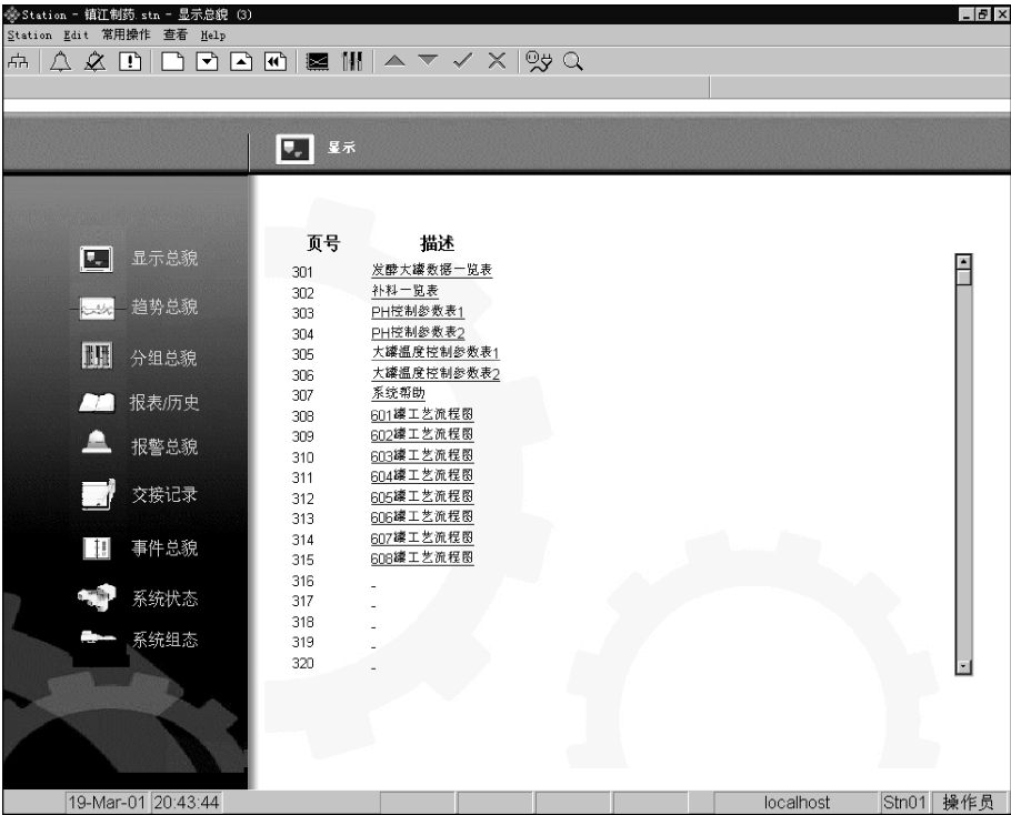
图 7-21 控制系统中的显示总貌画面
