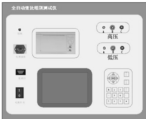
图 3-17 某变压器全自动变比极性测试仪面板示意图
