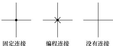
图 2.3 电路连接表示
