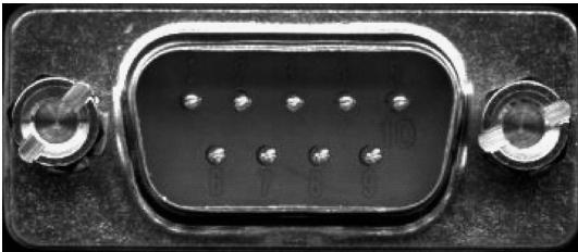
图 7-1 DB9 连接器示意图
