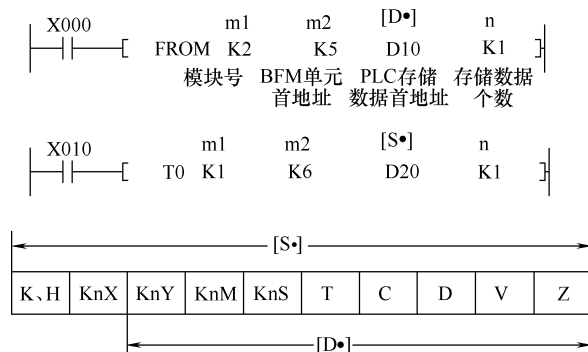
图 6-3 FROM、TO 指令的应用格式和使用范围
