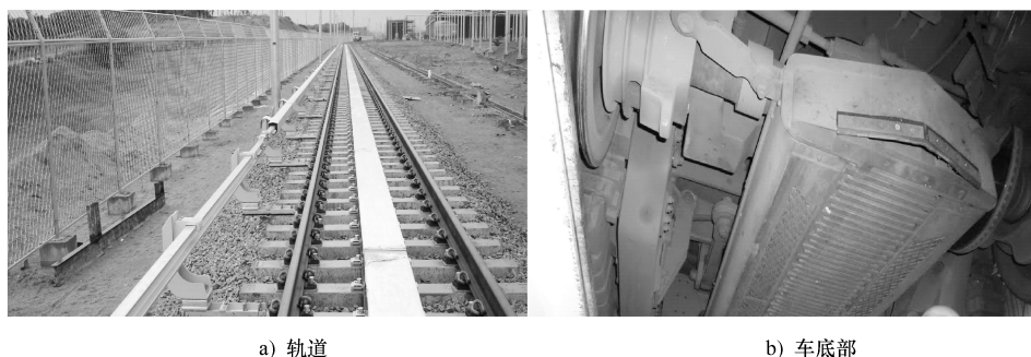
图 5-22 直线电动机轨道交通轨道及车底
