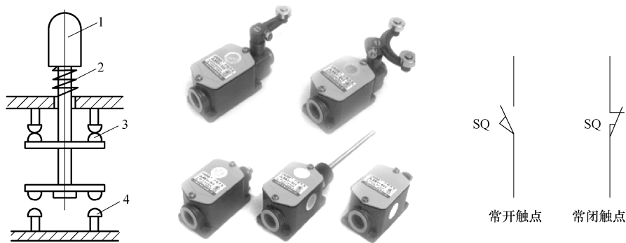
图 2-22 行程开关的外形及工作原理 1—滚轮 2—弹簧 3—动触点 4—静触点
